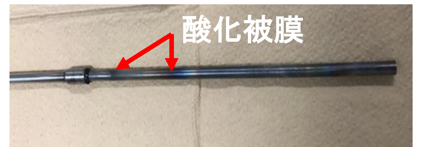
図3 水蒸気状トリチウムの閉じ込め実験結果とZr 管の酸化被膜の形成
